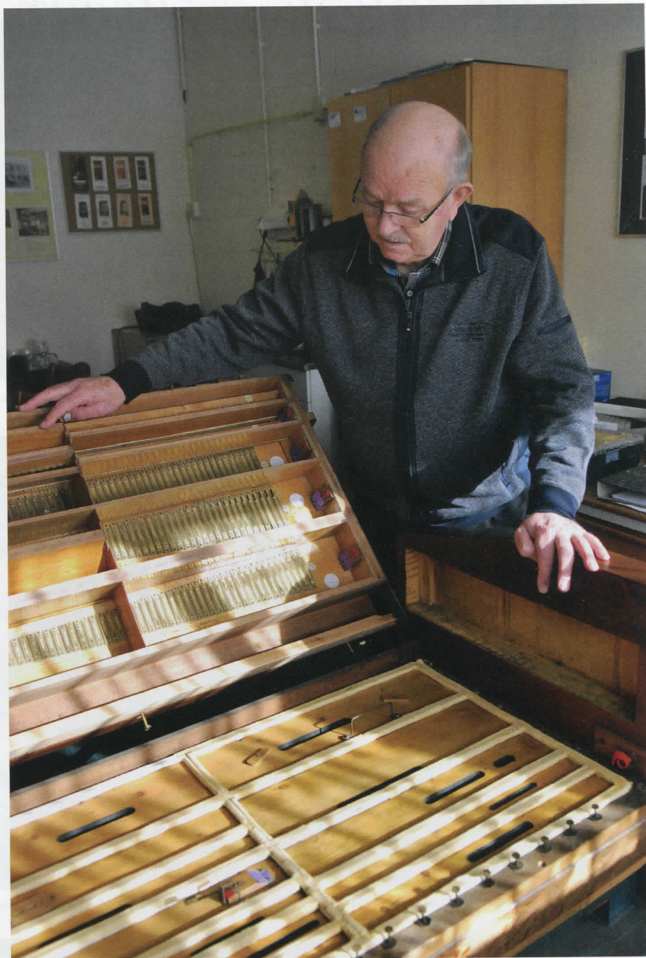
Jan Vos bij een opengeklapte windlade waarvan hij de tongen aan het stemmen is.
